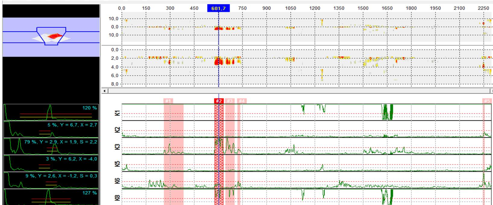
Дефектограмма с выявленным характерным дефектом (плоскотной, вдоль кромок, глубина залегания от 2 до 4 мм - предположительно несплавление кромок).
