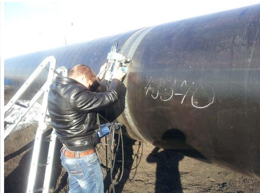
Проведение полевых испытаний сканера на строящемся объекте структуры «ОАО Газпром». Контроль СРС-шва толщиной 21.6 мм
