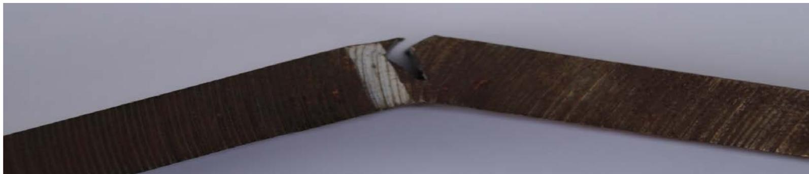
Образец №1 на изгиб: излом при  $40^\circ$  при допустимых  $120^\circ$
